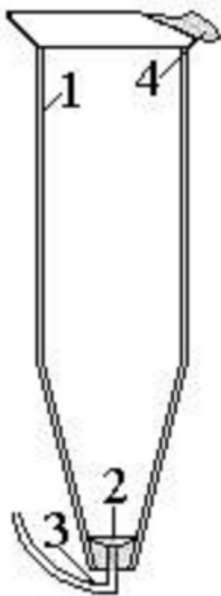
1 – стеклянная колба, 2 – распылитель, 3 – трубка подачи воды (воздуха), 4 – водосливной желоб
