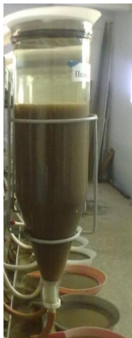
1 – стеклянная колба, 2 – распылитель, 3 – трубка подачи воды (воздуха), 4 – водосливной желоб
